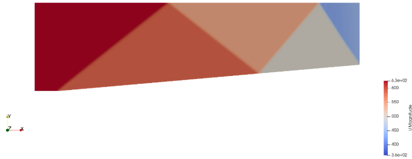
Рис. 5. Поле плотности установившегося течения для солвера rhoCentralFoam, \beta = 5^\circ
