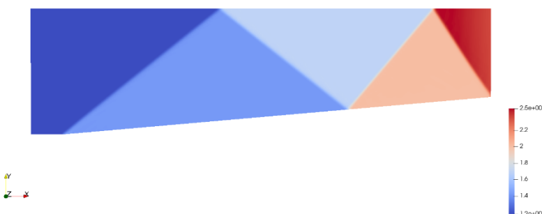
Рис. 4. Поле плотности установившегося течения для солвера rhoCentralFoam , \beta = 5^\circ
