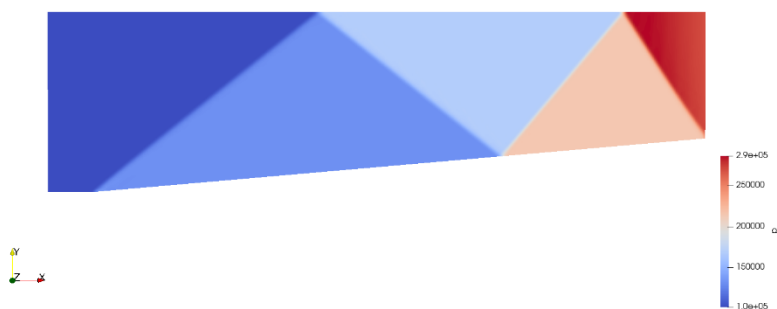
Рис. 3. Поле давления установившегося течения для солвера rhoCentralFoam , \beta = 5^\circ
